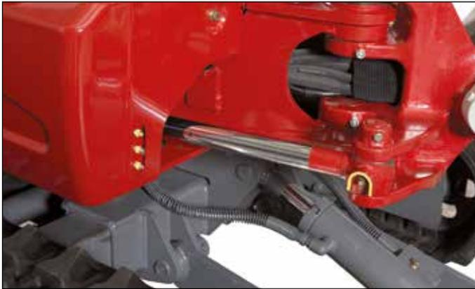
Robuster Schwenbock mit besonders geschützter Schlauchführung und hydraulischer Seitenversetzung.
