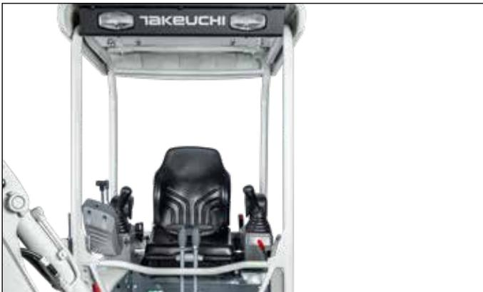
Fahrschutzdach mit ROPS (ISO12117), TOPS (ISO12117-2), OPG (ISO10262 Stufe1) und Komfortsitz (wetterfeste Ausführung) mit Sicherheitsgurt.
