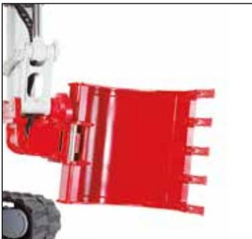
HUPPTilt mit HUPPPlate H, Tieflöffel als Hochlöffel montiert
